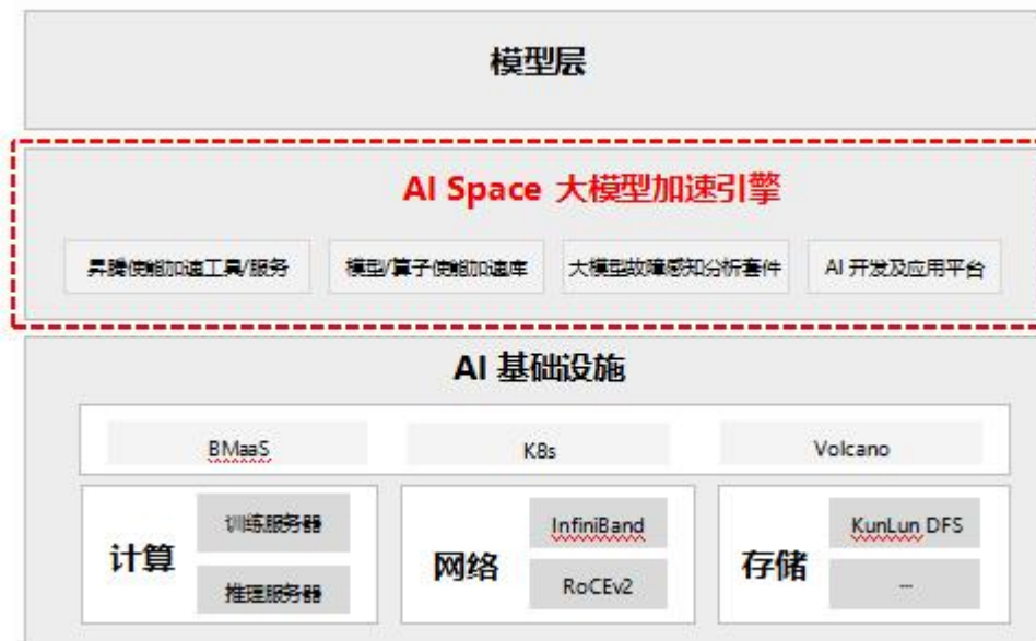
图1 KunLun AI Space 大模型加速引擎架构图
