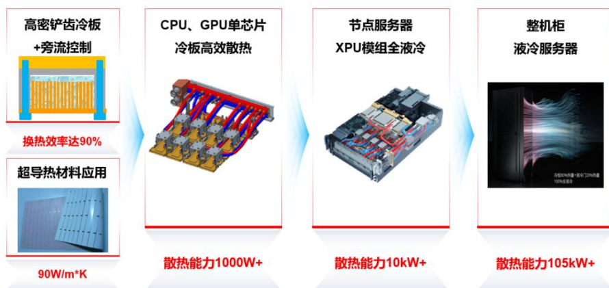
图1 FusionPoD for AI 从部件级到整柜的超强散热能力
